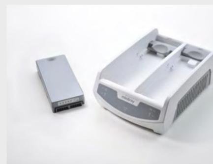
BeneHeart D1 con una batería de iones de litio admite más de 300 choques a 200 J o 200 choques a 360 J, así como 12 horas de monitorización. El cargador externo mantiene una batería de repuesto cargada y lista para usar.
