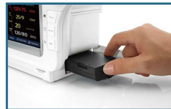
La batería de iones de litio, que no necesita mantenimiento, ofrece hasta 2,5 horas de energía de respaldo.
